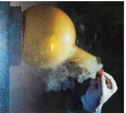
(0-4) شکل د سونډیم تعامل له کلورین ګاز سره
