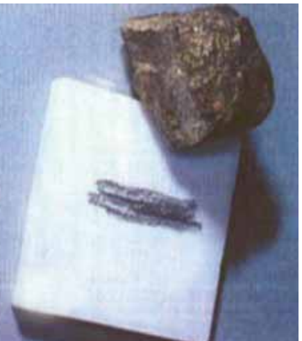
(۶-۱) شکل: د خط اثر پر سینیې کاشي تختې
