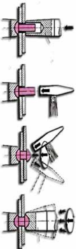
(۴-۱) شکل، د دوه ټوټې فلزاتو د پرچکارۍ مرحلې
