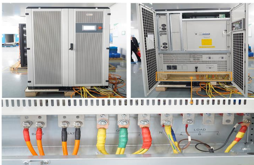
۱-۴ شکل: د هايبرېد انورټر داخلي او خارجي جوړښت
